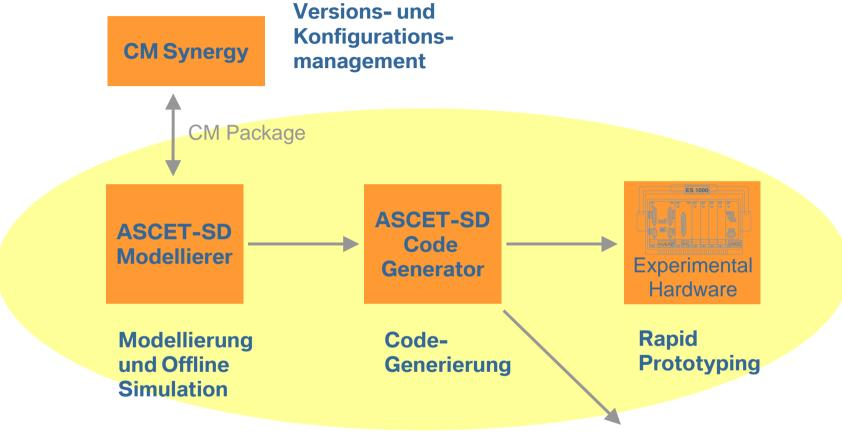
Aus einem ASCET-SD Modell kann C-Code für unterschiedliche Microcontroller generiert werden.
