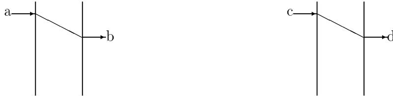
Abbildung 3.11: Beispiel zur Kombination zweier TSDs mit einer Disjunktion
