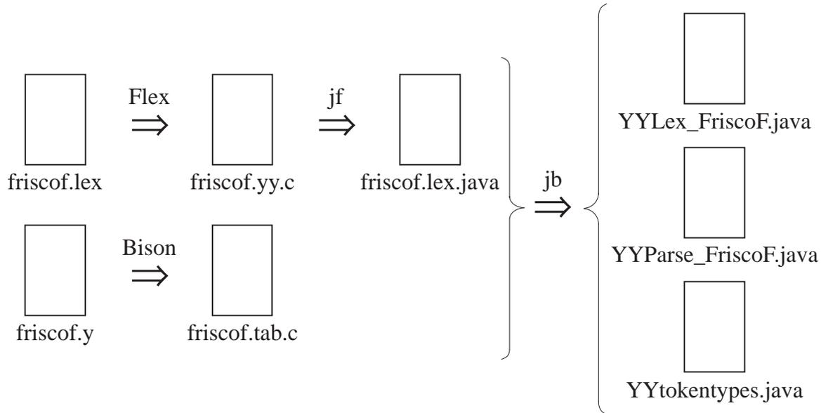
Abbildung 8.3: Die Erzeugung des Scanners und Parsers
