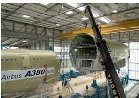
Komplexe Mess- & Regelungstechnik für den Betriebsfestigkeitsversuch am Airbus A380
