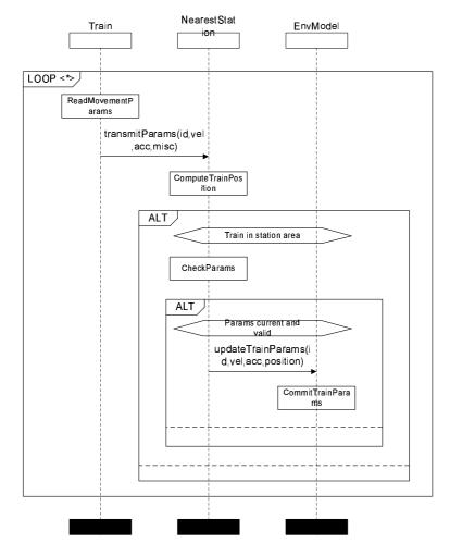
Fig. 8. MSC TrainSendPosition
